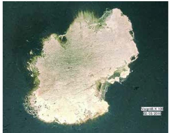
Kommt es zu mehreren Durchschlägen auf kleiner Fläche, besteht die Möglichkeit, dass der Selbstheileffekt in seiner Funktion gestört wird. Die Folge kann ein Ausfall des Kondensators sein.
